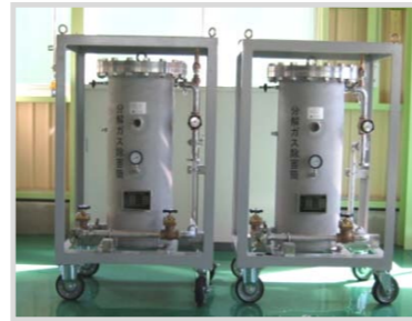
SF6回収作業分解・水分除去装置
