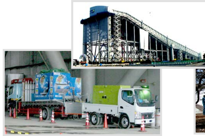
SF6液化回収装置(左)とSF6回収装置用発電機
