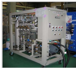
SF6ガス精製装置
