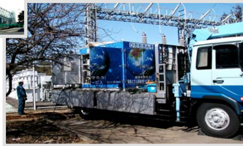
SF6液化回収装置
