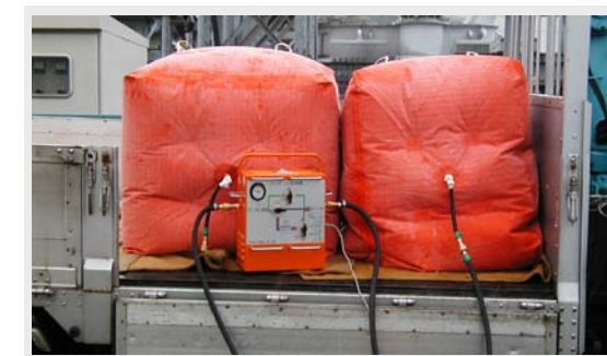
コンバスSF6回収装置(中央) 1m3/個:SF6回収ガスバッグ(左右)
