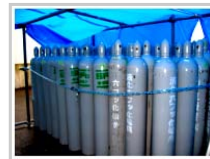
精製した液化SF6回収容器(ポンペ)
