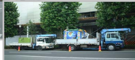
SF6回収装置用電源車(左)
